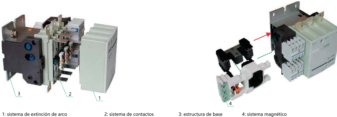
Esquema de la estructura de NC2-115~265
